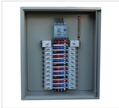
모델명 : TNMR-17 외 함 : STEEL 1.0T (500×700×150) 내 용 : MCCB 4P75A×1EA ELB 2P50A×2EA ELB 2P20A×10EA 가 격 : 문의 (철함 기준가) 외 함 : FRP BOX교환시 (650×700×170)
