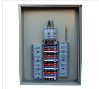
모델명 : TNMR-18 외 함 : STEEL 1.2T (700×900×150) 내 용 : MCCB 4P150A×1EA MCCB 4P100A×2EA ELB 4P75A×2EA ELB 4P50A×4EA 가 격 : 문의 (철함 기준가) 외 함 : FRP BOX교환시 (650×850×200)
