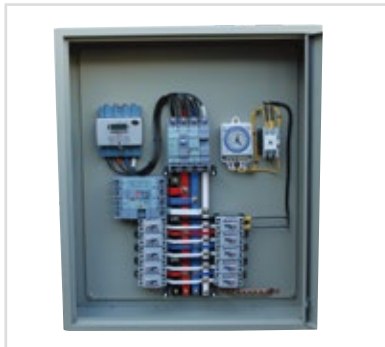
모델명 : TNMR-19 외 함 : STEEL 1.0T (600×700×150) 내 용 : MCCB 4P50A×1EA ELB 4P30A×1EA ELB 2P20A×10EA M/G & TIMER(옵니) 전자식계량기-40(10A) 가 격 : 문의 (철함 기준가) 외 함 : FRP BOX교환시 (650×700×200)
