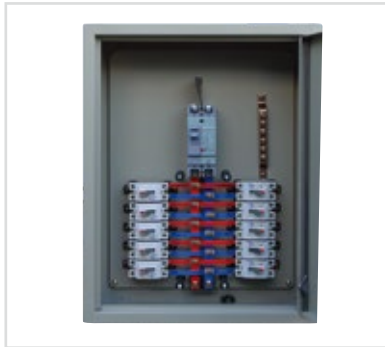
모델명 : TNMR-16 외 함 : STEEL 1.0T (400×500×150) 내 용 : MCCB 2P75A×1EA ELB 2P20A×10EA 가 격 : 문의 (철함 기준가) 외 함 : FRP BOX교환시 (650×550×170)
